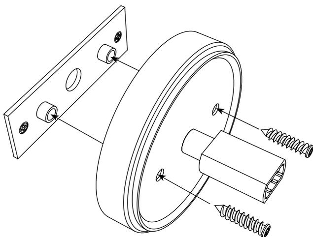
Fixer le support et le cache fil au mur à l'aide des deux vis.
