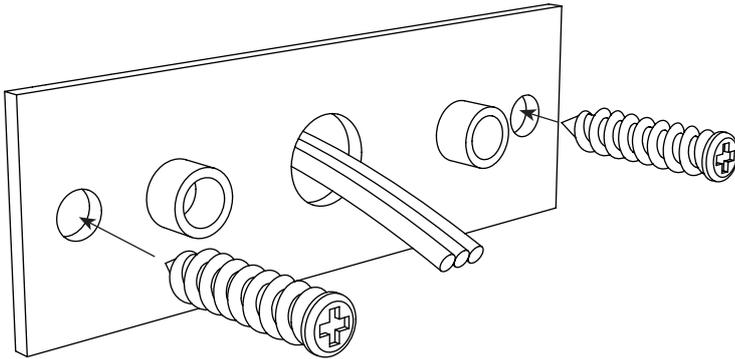
Positionner le support sur le mur de sorte que le câble passe par le trou central du support et fixer le support au mur à l'aide des deux vis.
