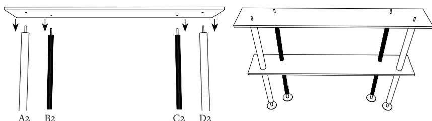
Placer le plateau dans les 4 tiges filetées des 4 tubes A2, B2, C2 et D2.
