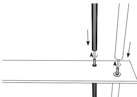
Insérer les 4 tiges filetées des 4 tubes en tournant A2, B2, C2 et D2 dans l'écrou de couplage fixé au plateau.
