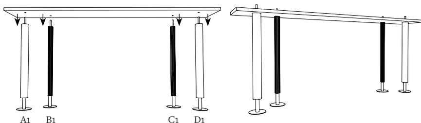
Placer le plateau de largeur 50 cm dans les 4 tiges filetées des 4 tubes (A1, B1, C1 et D1).
