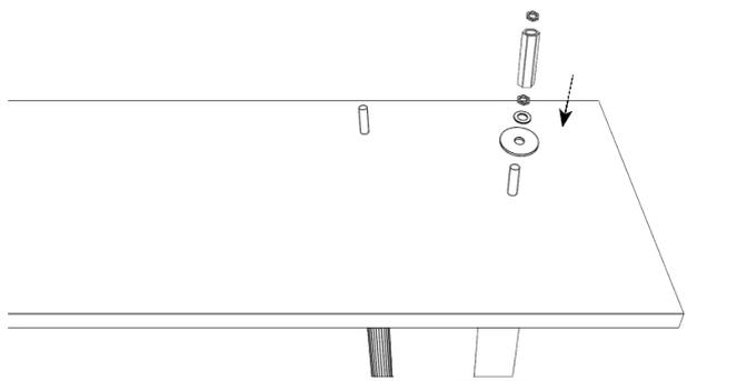
Assembler sur les tiges filetées des 2 tubes A2 et D2 dans cet ordre: la grande rondelle, la petite rondelle, l'écrou et enfin l'écrou de couplage.
