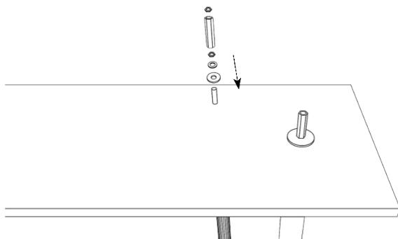
Assembler sur les tiges filetées des 2 tubes B2 et C2 dans cet ordre: la moyenne rondelle, la petite rondelle, l'écrou et enfin l'écrou de couplage.
