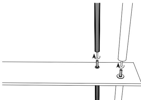
Insérer les 4 tiges filetées des 4 tubes en tournant A3, B3, C3 et D3. dans l'écrou de couplage fixé au plateau.
