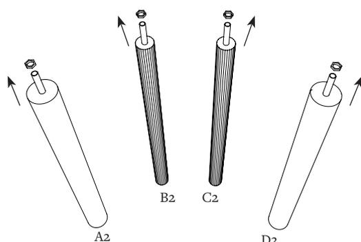
Dévisser l'écrou sur les tiges filetées des 4 tubes A2, B2, C2 et D2.
