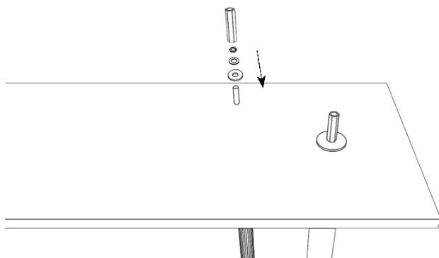
Assembler sur les tiges filetées des 2 tubes B1 et C1 dans cet ordre: la moyenne rondelle, la petite rondelle, l'écrou et enfin l'écrou de couplage .
