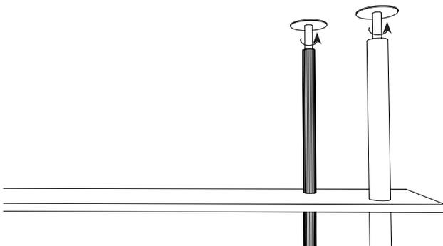
Visser la partie supérieure des derniers tubes A4, B4, C4 et D4. en tournant jusqu'à ce que la platine touche le plafond et que le tube cesse de bouger.
