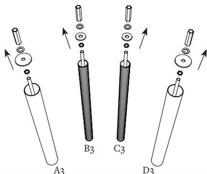
Dévisser l'écrou, les 2 rondelles et l'écrou de couplage sur les tiges filetées des 4 tubes A3, B3, C3 et D3.
