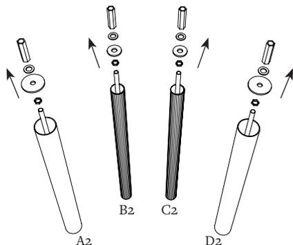
Dévisser l'écrou, les 2 rondelles et l'écrou de couplage sur les tiges filetées des 4 tubes A2, B2, C2 et D2.
