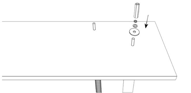
Assembler sur les tiges filetées des 2 tubes A1 et D1 dans cet ordre: la grande rondelle, la petite rondelle, l'écrou et enfin l'écrou de couplage .
