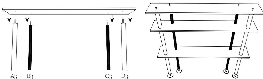
Placer le plateau dans les 4 tiges filetées des 4 tubes A3, B3, C3 et D3..
