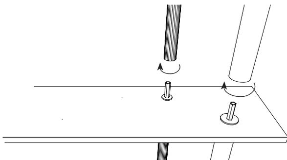
Insérer les 4 tiges filetées des 4 tubes en tournant A4, B4, C4 et D4. dans l'écrou de couplage fixé au plateau.
