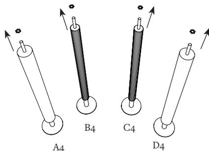
Dévisser l'écrou sur les tiges filetées des 4 tubes A4, B4, C4 et D4.
