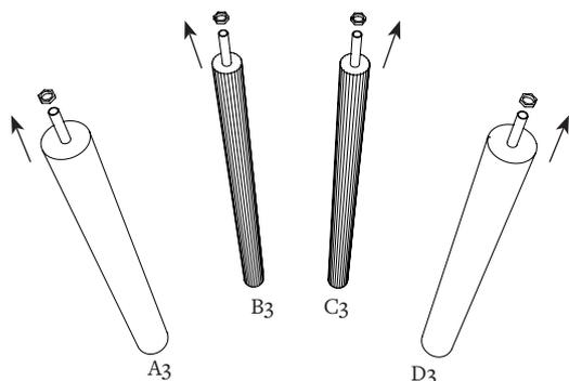
Dévisser l'écrou sur les tiges filetées des 4 tubes A3, B3, C3 et D3.
