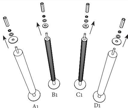
Dévisser les 2 rondelles, l'écrou et l'écrou de couplage sur les tiges filetées des 4 tubes (A1, B1, C1 et D1).
