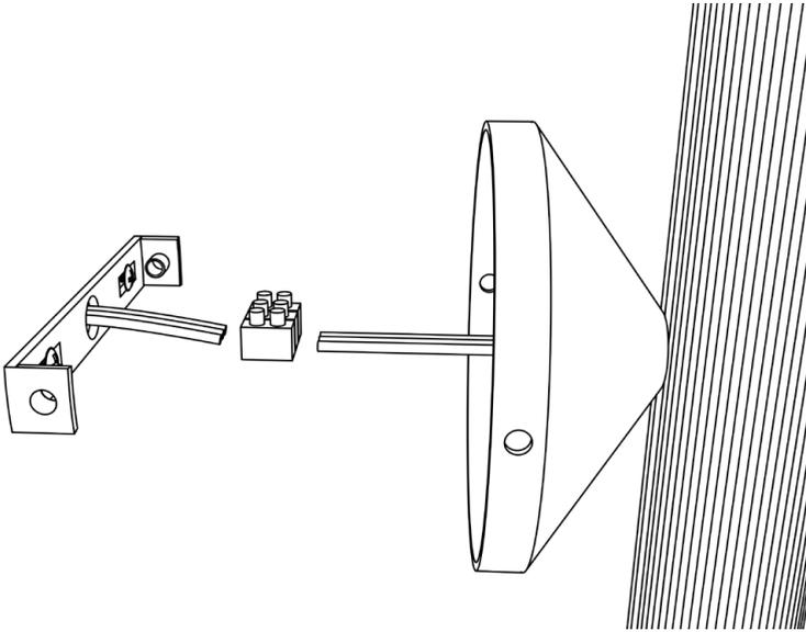
Connecter les câbles au réseau électrique.
