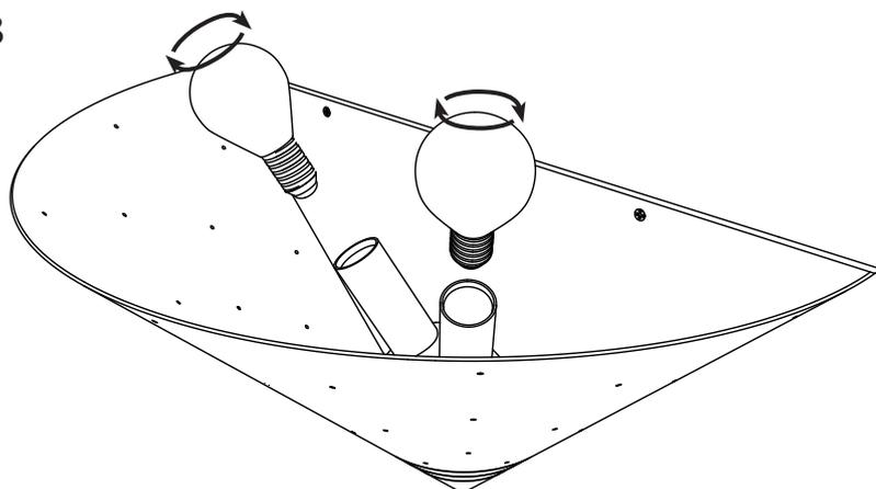
Insérer les ampoules dans les culots.
