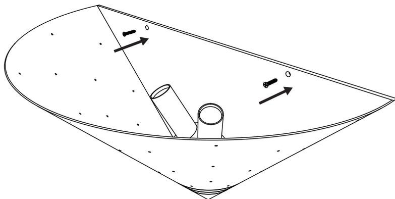
Positionner l'applique contre le mur et l'y fixer avec les deux vis.
