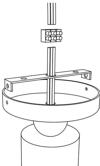
Connecter les câbles au réseau électrique.
