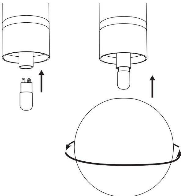
Insérer l'ampoule dans le culot.
