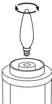
Insérer l'ampoule dans le culot.
