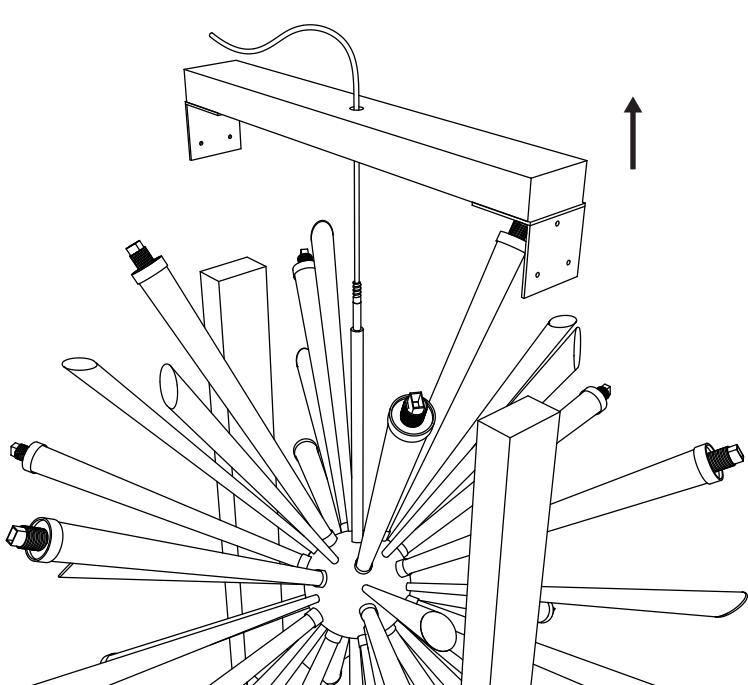
Dégager doucement le tasseau supérieur du tréteau, en le faisant passer le long du câble électrique.
