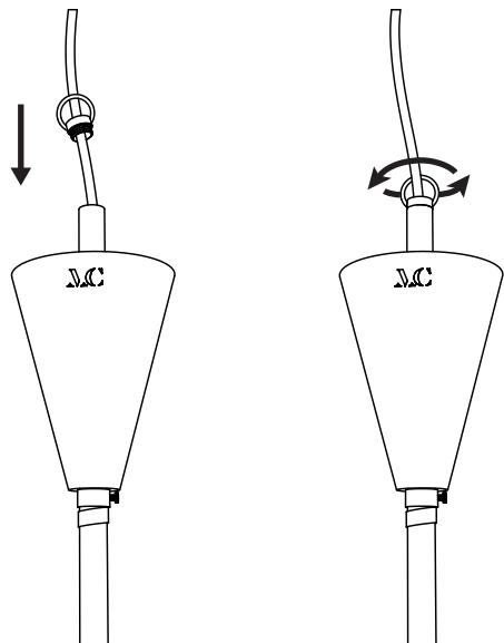
Prendre l'anneau dévissé du tube plus tôt et passer le câble électrique à l'intérieur, puis revisser l'anneau sur le tube.
