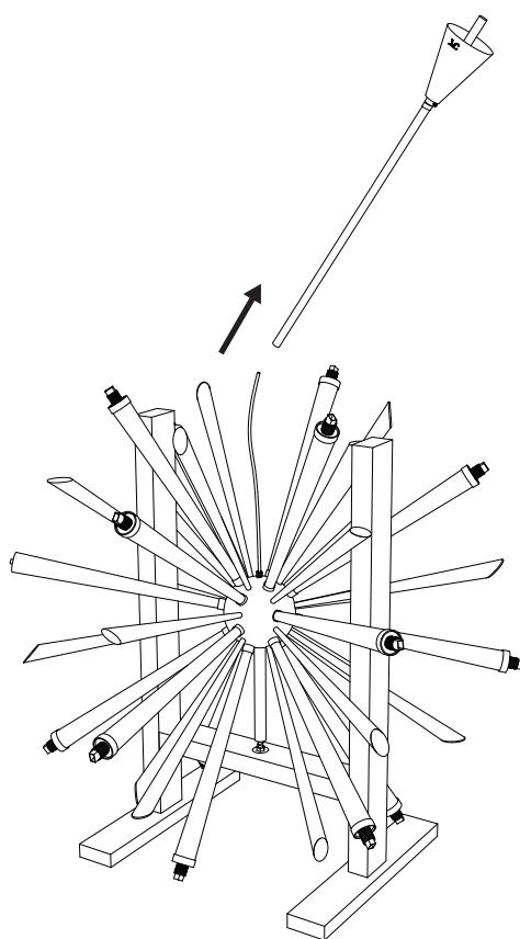
Prendre le tube et le cache fil préparés précédemment, faire passer le câble électrique du lustre dans le tube et le faire ressortir de l'autre côté.
