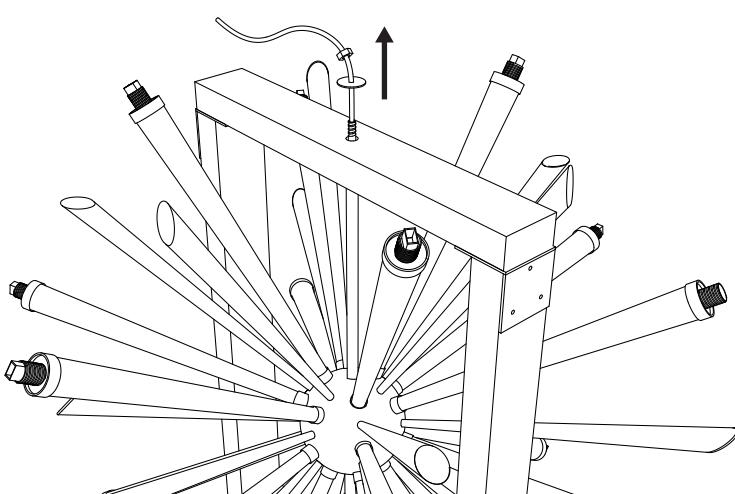
Retirer le boulon et la rondelle au sommet du tréteau en les faisant passer le long du câble électrique.
